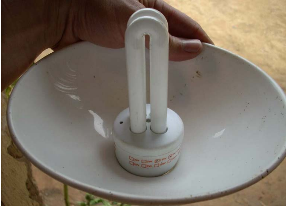
Fotografía 10. Lámpara CFL de 11W con reflector como instalada en el proyecto de SFV en Sillani (Mun. de Padilla).
